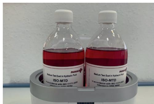
Gemäß ISO 11171 muss die Zusammensetzung von Sekundärkalibriersuspensionen mit einem primärkalibrierten Master-Partikelzähler ausgezählt werden. Vor diesem Test wird die fertige Suspension im Ultraschallbad homogenisiert.
