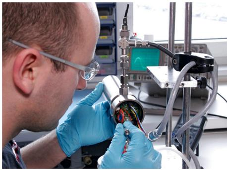
*Der After-Sales-Service von PAMAS kann auch direkt vor Ort beim Kunden in Anspruch genommen werden. Für den Außendienst speziell ausgebildete Servicetechniker reisen hierfür mit der entsprechenden Ausrüstung an, die für die normgerechte Kalibrierung von automatischen Partikelzählern erforderlich ist. (Foto: PAMAS)*
