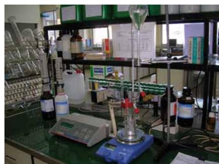
**Figura 8** equipo para la determinación del punto de inflamación
