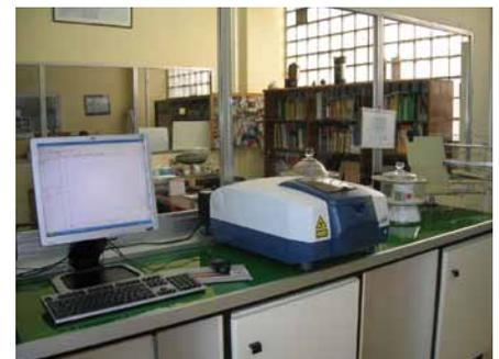
**Figura 6** equipo para la determinación de asfaltenos
