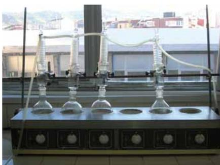
**Figura 7** equipo para la determinación del número básico
