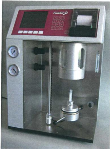
**Abbildung 5:** Für die Analyse von Proteinlösungen werden Partikelzählsysteme mit einer kleineren Druckkammer ausgestattet. So können auch geringere Probenmengen höherer Viskosität unter Druck analysiert werden.
