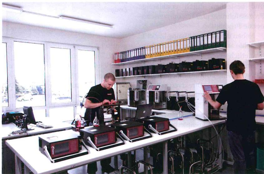
Am Firmenhauptsitz in Rutesheim bei Stuttgart entwickelt, fertigt und vertreibt die PAMAS GmbH automatische Partikelzähler für Flüssigkeiten (Quelle: PAMAS).
