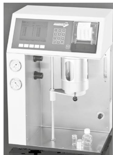
Le système d'analyse de particules PAMAS SBSS peut être équipé en option d'un petit dôme sous pression pour les liquides plus visqueux. Avec l'aide de cette fonction, les volumes d'échantillons plus petits de viscosité plus élevée, comme les injections de protéines thérapeutiques, peuvent être analysés selon USP 787 (photo © PAMAS)
