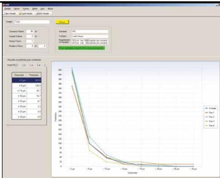
Les systèmes de comptage de particules peuvent être équipés d'un logiciel pour présenter des résultats de mesure en conformité avec la pharmacopée internationale. Le résultat de mesure du logiciel procédural pharmaceutique PAMAS USP indique si l'échantillon répond à l'exigence selon USP 787 (Subvisible particules en protéine thérapeutique injections), par USP 788 (particules en injections) ou par USP 789 (particules dans les solutions ophtalmiques). (Capture d'écran © PAMAS)
