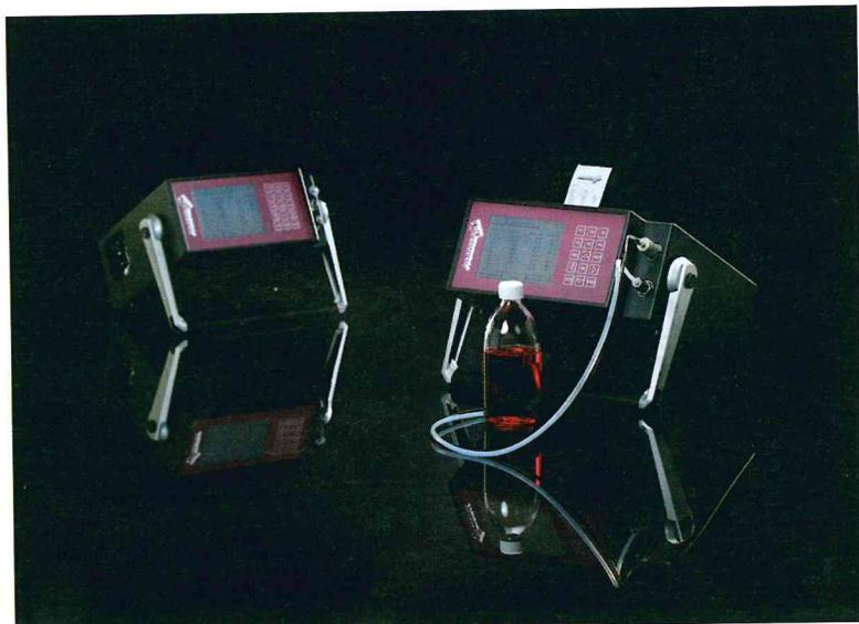
Doté d'un réducteur de pression intégré, le Pamas S40 peut mesurer la contamination de fluides sous pression. Sa conception lui permet également de ne pas être affecté par les environnements difficiles.
