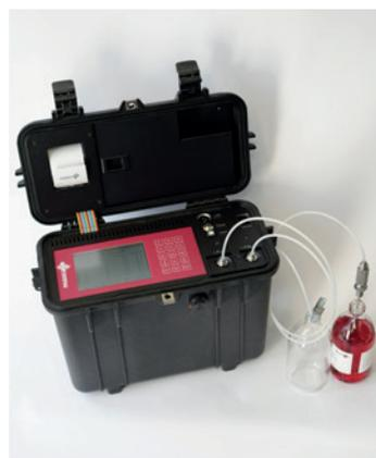
*Für die Probenahme aus Probenflaschen ist das PAMAS S40 GO AVTUR mit einer Flaschensonde ausgestattet.*
