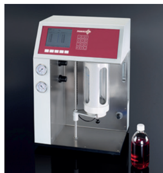
L'appareil de mesure PAMAS SBSS est un compteur de particules pour échantillons de viscosité élevée.
