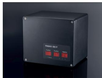
PAMAS S50 P mit eingebauter Pumpe für drucklose Messstellen
