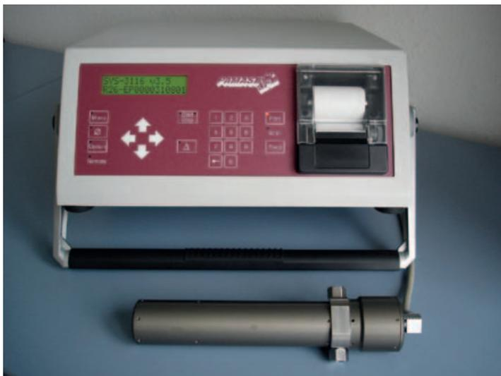
Im Floc Size Analyser PAMAS FSA-2002 sind der Partikelzähler PAMAS 3116 sowie der Lichtabschattungssensor PAMAS HCB-LD-900 integriert. Die hochwertige Sensortechnologie von PAMAS ist Garant für höchste Messgenauigkeit und für die Reproduzierbarkeit der Messergebnisse.
