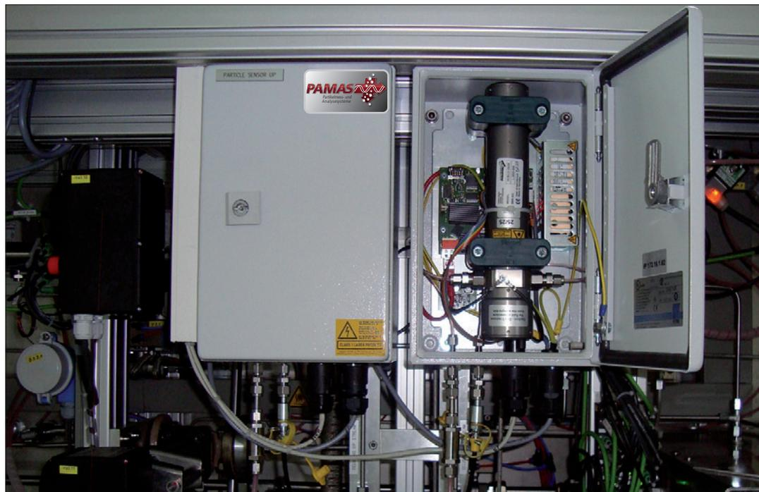
Dank seines kompakten Designs kann das Online-Partikelzählsystem PAMAS 4132 leicht in bestehende Teststände integriert werden.
