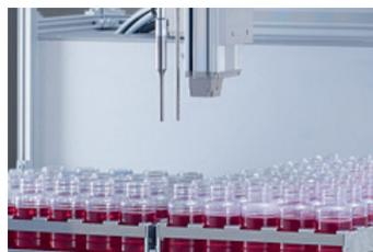
Probenahme- und Ultraschallsonde
