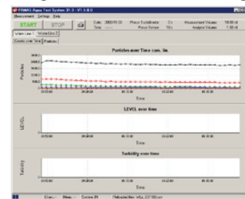
Grafische Anzeige der Partikelanzahlen während eines bestimmten Zeitraums
