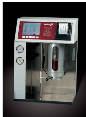
PAMAS SBSS pour les liquides haute viscosité ou à haute pression de vapeur.
