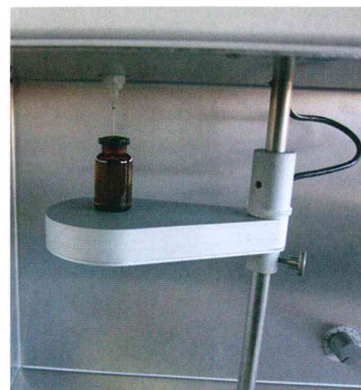
Abb. 3: Mithilfe der integrierten Probenzufuhr kann die Probenflüssigkeit für die Partikelmessung direkt aus dem Originalbehälter entnommen werden. Ein zusätzlicher Umfüllvorgang und die damit verbundene Gefahr einer nachträglichen Verunreinigung werden auf diese Weise umgangen.
