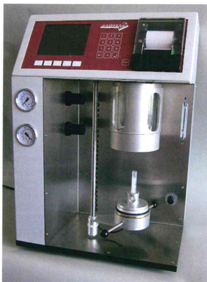
Abb. 5: Optional können Partikelzählsysteme mit einer kleineren Druckkammer ausgestattet werden. So können auch geringere Probenmengen höherer Viskosität unter Druck analysiert werden.
