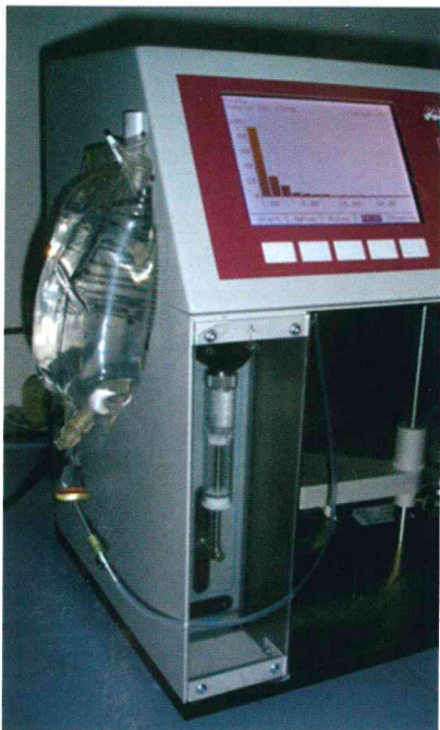
Abb. 4: Infusionslösungen können mithilfe speziellen Zubehörs am Partikelzähler befestigt werden und direkt aus dem Behälter heraus analysiert werden.
